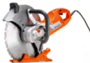
HUSQVARNA K 3000 VAC Электродвигатель, диаметр диска – 350 мм, 230/120/110 В, 2700/1800/2200 Вт, 7,9 кг (без пылеотвода), пылеотвод – 1,0 кг, глубина резания 119 мм, Elgard™ и SoftStart™. Поставляется в Россию.
