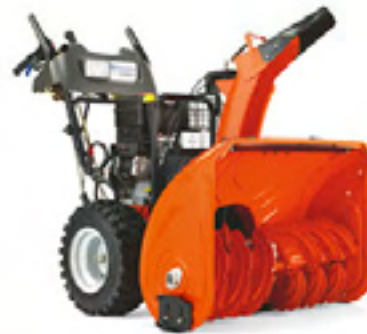
HUSQVARNA ST 268EP Briggs & Stratton 1450 Series, 7,1 кВт при 3600 об/мин, рабочая ширина – 68 см, двухступенчатая система, запуск от электрической розетки, легкое маневрирование. Поставляется в Россию.
