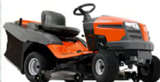
HUSQVARNA CTH 194 KOHLER® Courage, 9,2 кВт при 2500 об/мин, гидростатическая трансмиссия. Ширина кошения: 107 см. U-Cut™. Диаметр нескошенного круга*: 70 см. Объем травосборника: 320 л. Включение BioClip с сиденья. Не поставляется в Россию.
