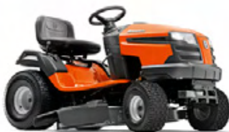
HUSQVARNA LT 154 Briggs & Stratton Intek, 8,6 кВт при 2500 об/мин, механическая трансмиссия. Ширина кошения: 97 см. Диаметр нескошенного круга*: 137 см. Поставляется в Россию.
