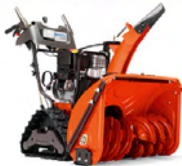
HUSQVARNA ST 276EPT Briggs & Stratton 1650 Series, 7,3 кВт при 3600 об/мин, рабочая ширина – 76 см, гидростатическая трансмиссия, двухступенчатая система, гусеничная система привода, запуск от электрической розетки, легкое маневрирование. Поставляется в Россию.
