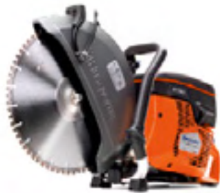
HUSQVARNA K 760 Бензиновый двигатель, диаметр диска 300/350 мм, 74 см³, 3,7 кВт, 9,6/9,8 кг, глубина резания 100/125 мм, X-Torq, Active Air Filtration™, SmartCarb™, Airpurge и EasyStart. Поставляется в Россию.
