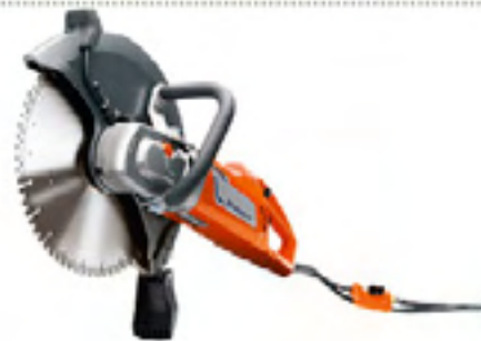
HUSQVARNA K 3000 WET Электродвигатель, диаметр диска 350 мм, 230/120/110 В, 2700/1800/2200 Вт, 8,5 кг, глубина резания 125 мм, Elgard™ и SoftStart™. Вакуумная насадка предлагается как аксессуар для сухой резки с минимальным количеством пыли. Поставляется в Россию.
