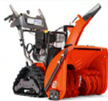
HUSQVARNA ST 268EPT Briggs & Stratton 1450 Series, 7,1 кВт при 3600 об/мин, рабочая ширина – 68 см, гидростатическая трансмиссия, двухступенчатая система, гусеничная система привода, запуск от электрической розетки, легкое маневрирование. Поставляется в Россию.
