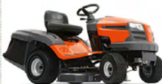
HUSQVARNA CT 154 Briggs & Stratton Intek, 8,6 кВт при 2500 об/мин, механическая трансмиссия. Ширина кошения: 97 см. Диаметр нескошенного круга*: 107 см. Объем травосборника: 220 л. Заглушка BioClip входит в комплектацию. Поставляется в Россию.
